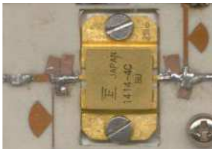
Figure 1 : Exemple de plusieurs stubs d'un étage 3 cm
