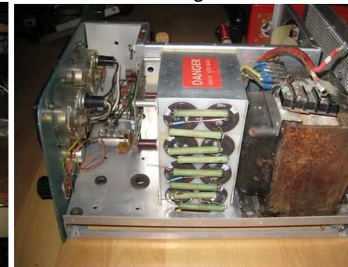
Construction de la partie HF d'entrée, le commutateur de self du PA et la fixation définitive des condensateurs variables.
