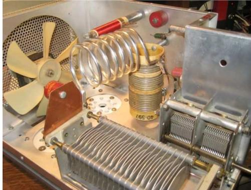
Début du câblage sous châssis, des supports des tubes et des câbles coaxiaux téflon vers le relais E/R
