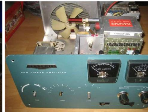
Le premier travail de câblage a été celui de l'assemblage du bloc de condensateurs de filtrage de l'alimentation.
