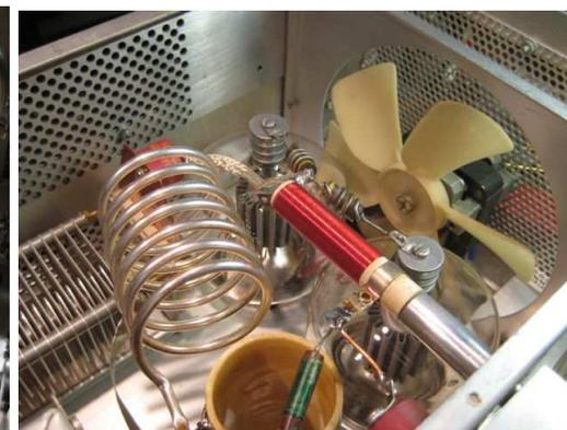
Câblages des alimentations secteur et installation du transformateur filament rembobiné.
