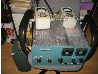
Un ajustement du filtre passe bande d'entrée sur 21 MHz sera nécessaire mais le noyau est coincé.
